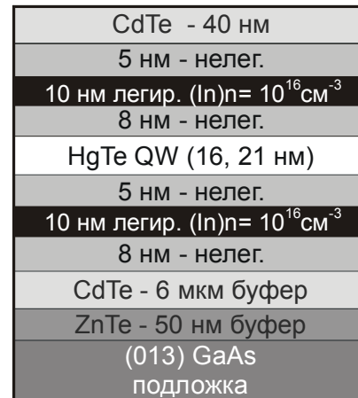
Рис.1. Схема эпитаксиальной структуры с HgTe квантовой ямой.
