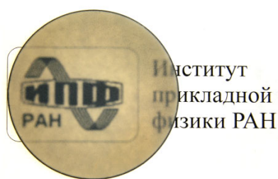
Рис.5(а). Алмазный диск диаметром 75 мм, толщиной 0,65 мм, выращенный в ИПФ РАН.
