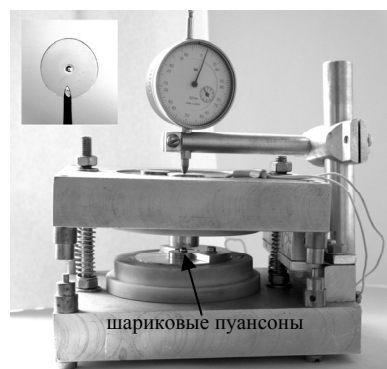
Рис.1. Пресс для горячей штамповки рентгеновских рефракционных линз. Во вставке представлена фотография одиночной линзы.
